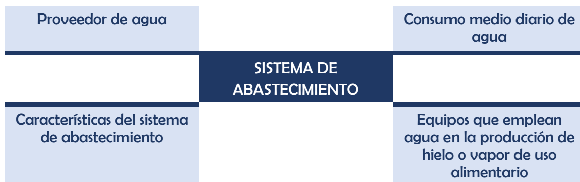
Figura 10.- Elementos que caracterizan un sistema de abastecimiento.
